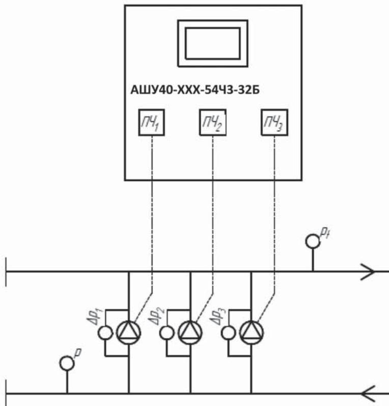
**Шкаф управления с преобразователями частоты на каждый насос.**
