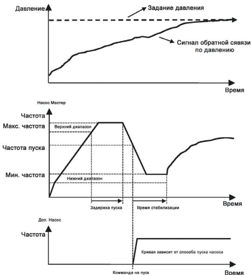
Рис.1. Временная диаграмма пуска дополнительного насоса
