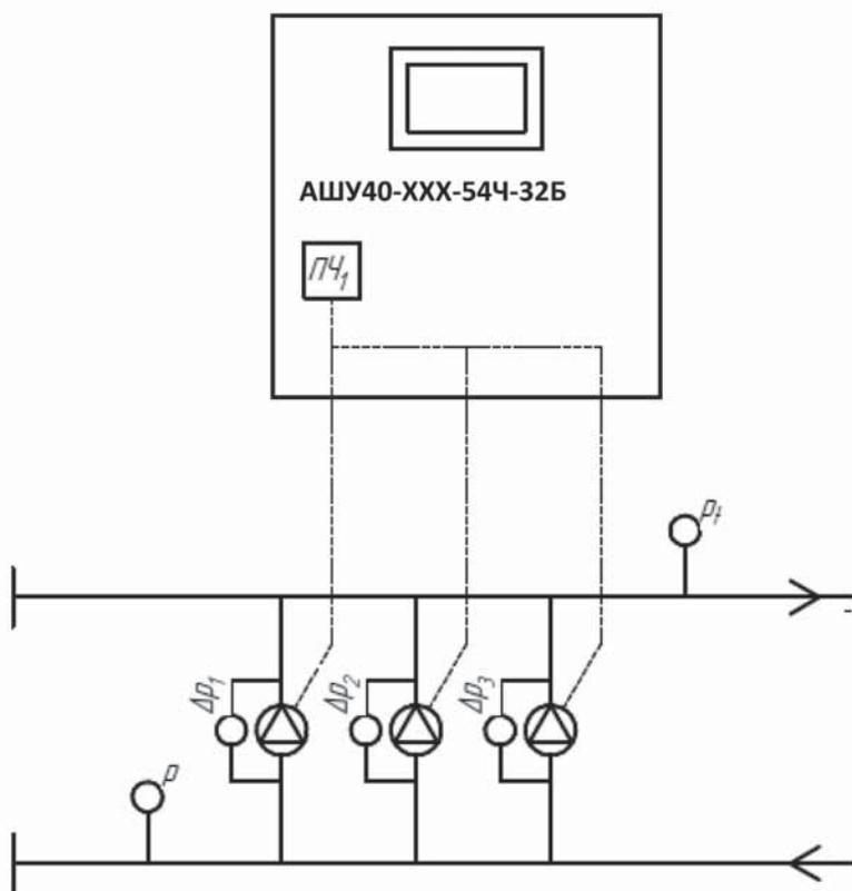
**Шкаф управления с преобразователем частоты на группу насосов.**
